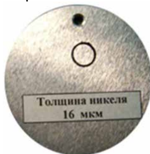
Натурная мера толщины металлического покрытия на образцовом основании (электролитический никель толщиной h_{\text{макс}} = 16 \text{ мкм} )
